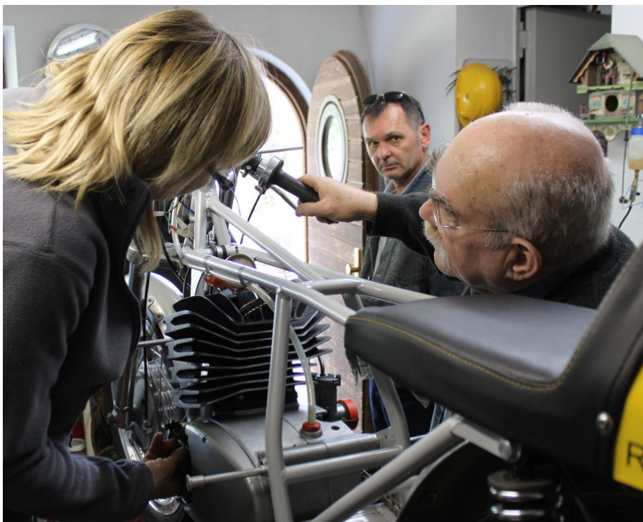
Abbildung 4.1: Einstellarbeiten an der Zündung
