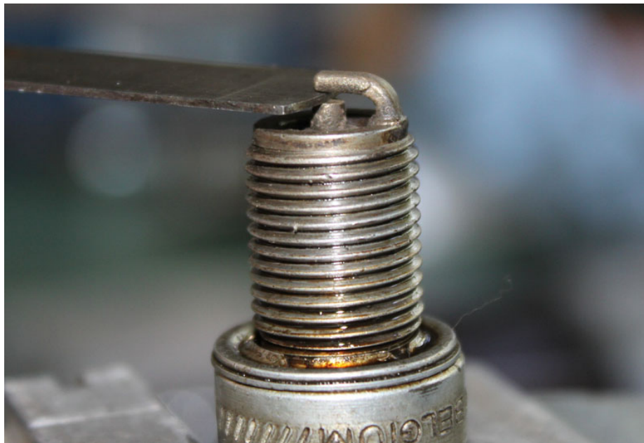
Abbildung 4.8: Überprüfen des Elektrodenabstands
