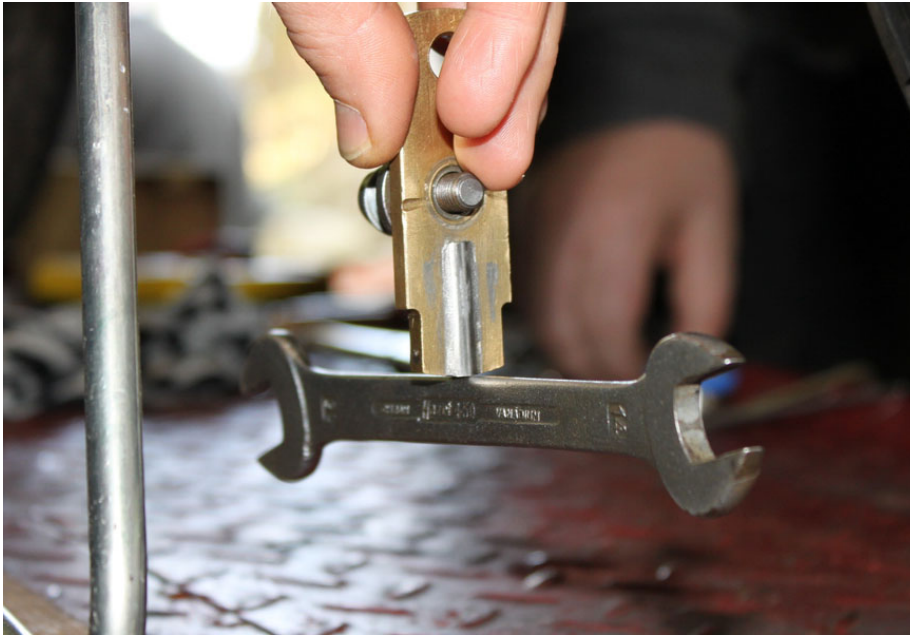
Abbildung 4.7: Überprüfen der Magnetkraft gemäß Maico Werksnorm
