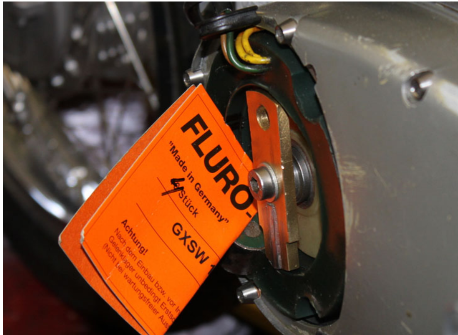
Abbildung 4.4: Festklemmen des Innenrotors mit einem Stück Pappe
