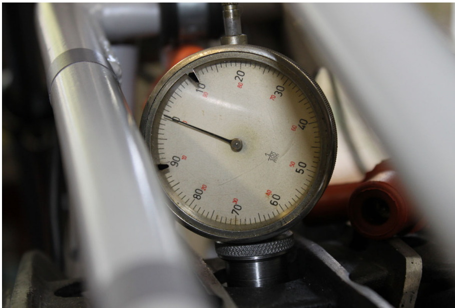
Abbildung 4.3: Messuhr in 0-Stellung
