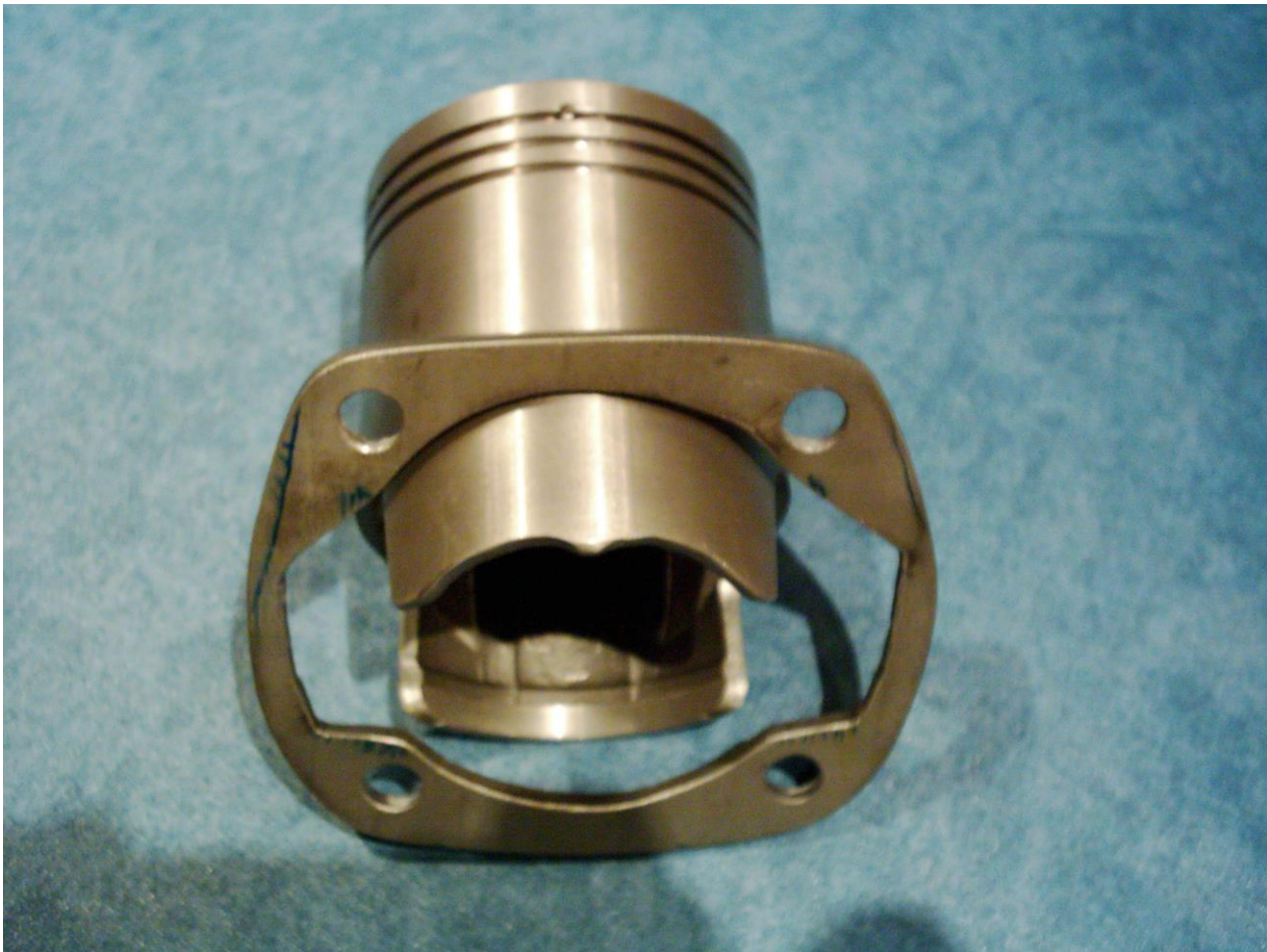
Bild 5: ETZ-Kolben und 5 mm starke Distanzplatte aus Aluminium in Form einer Zylinderfußdichtung. Das Kolbenhemd wurde einlaßseitig an die Kontur des Einlaßkanal angepaßt. Die Distanzplatte kann mit Bohrmaschine, Stichsäge und Feile in ca. einer Stunde selbst hergestellt werden.
