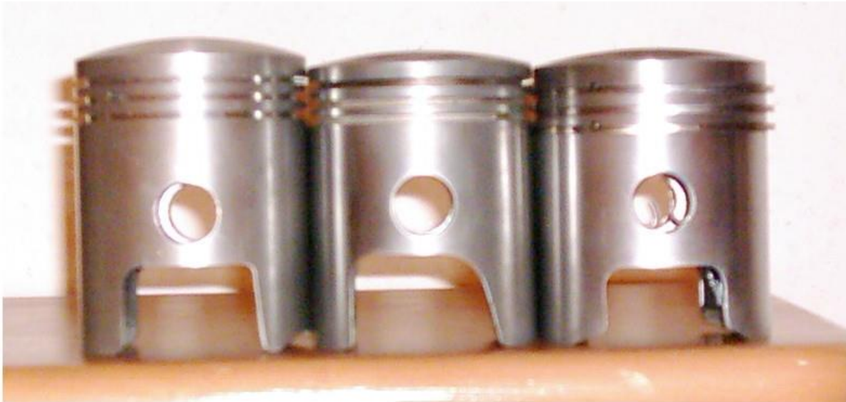
Bild 1: Kolben von links nach rechts: ETZ 250 – Maico 250 – ES 250
