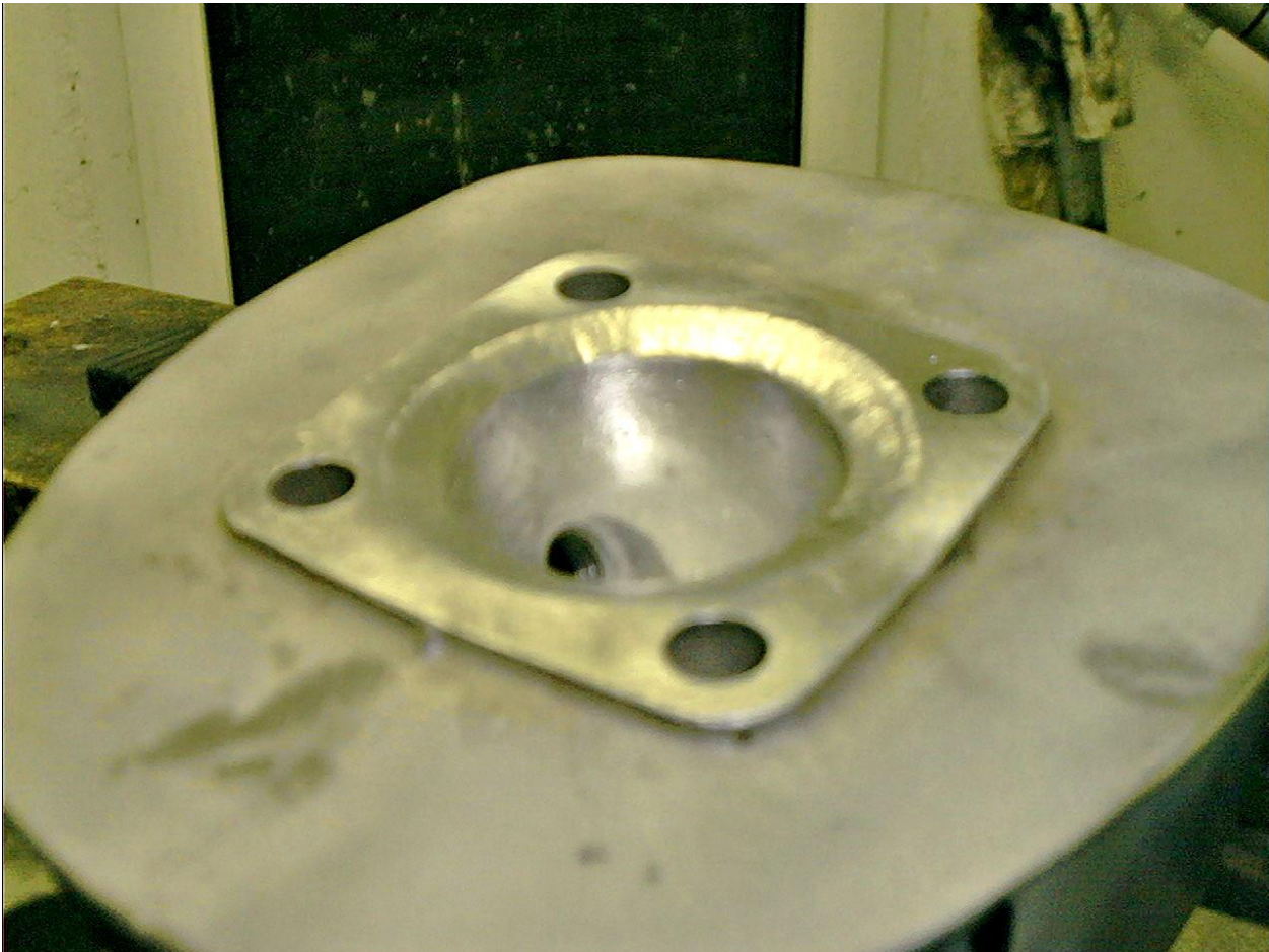
Bild 4: Mit Feile und Dremel auf 71mm Durchmesser nachbearbeiteter Zylinderkopf. Das könnte man natürlich mit einer professionellen Fräsmaschine schöner machen, aber die Handarbeit wird ihren Zweck auch erfüllen.
