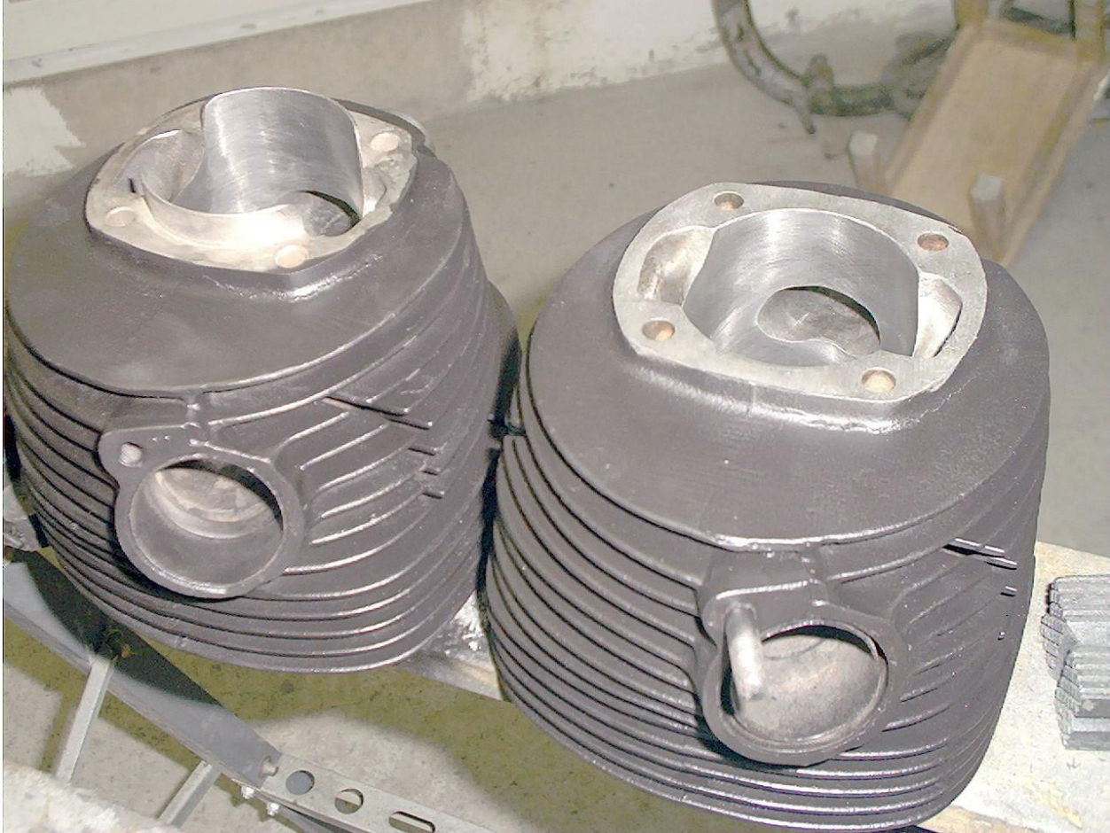
Bild 2: Zwei frisch gehonte Zylinder nach dem lackieren. Der eine im Durchmesser 69,5mm hat noch die Buchsenüberstände, beim anderen mit 71mm Durchmesser fehlen diese. Man beachte auch die Auslaßstutzen. Der linke Zylinder hat die Ausführung ohne, der rechte die Ausführung mit Innenring zur besseren Abdichtung.
