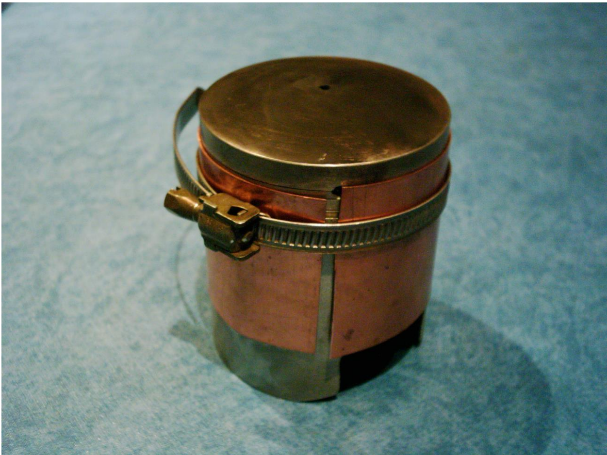
Bild 3 : Selbstgebautes Kolbenringspannband aus Kupferblech als Montagehilfe.
